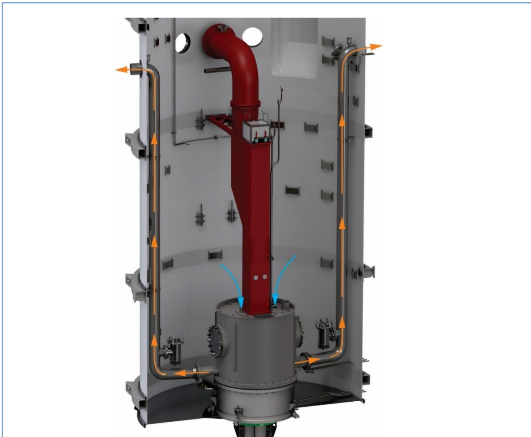
Figuur 6-6: POCS: geforceerde, neerwaartse koelwaterstroom door het Reflector Vessel
